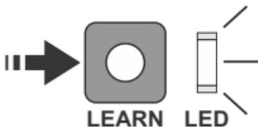
Observe que o led da função learn se acenderá, mantenha pressionado o botão de learn, quando o LED se apagar os transmissores terão sido apagados.
